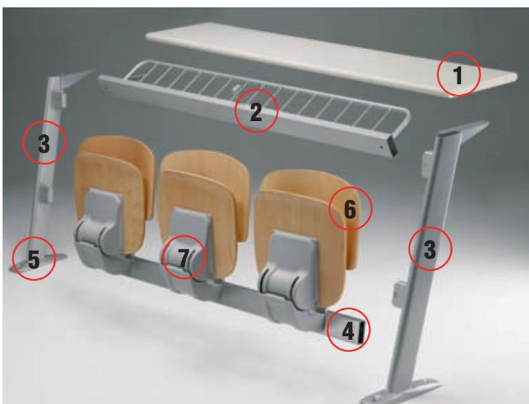
Tutte le parti metalliche sono verniciate, previa preparazione del sottofondo mediante degrassaggio e fosfatazione, con polveri epossipoliesteri, ecologiche e atossiche, polimerizzate in galleria termica a 200° con uno spessore non inferiore a 60 micron; colore grigio alluminio. Saldature effettuate a filo continuo.
